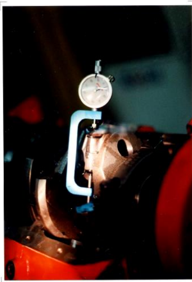
Bild 6: Festziehen der Pleuelschrauben mit Dehnungsmeßschr. auf eine Dehnung von 0,006“.
