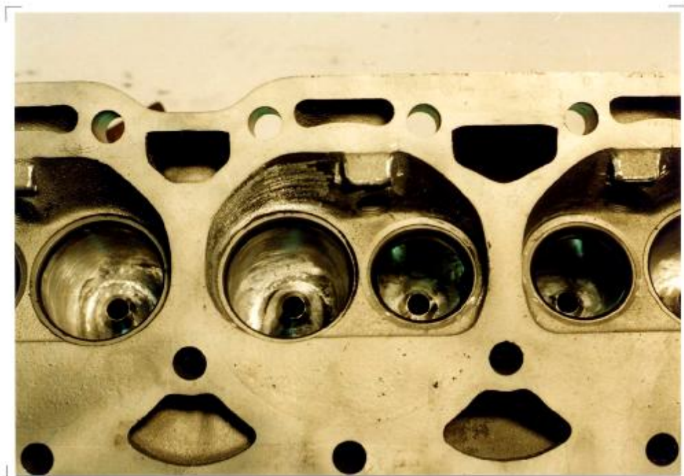
Bild 15: Nach der Fertigstellung der „Valve Bowls“ : Angeglichene Ventilsitzringe, entfernte Kanalkanten und bearbeitete Ventilführungen. Die Ventilsitze sind hier noch nicht gefräst und der Brennraum ist noch fast unbearbeitet.
