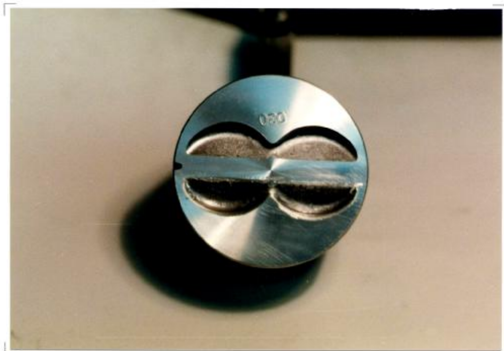
Bild 5: Um die Klingelneigung des Motors zu verringern, wurden die Ventiltaschenkanten entgratet und abgerundet. Die oberen beiden V.-Taschen wurden zum Vergleich zunächst im Ursprungszustand belassen.
