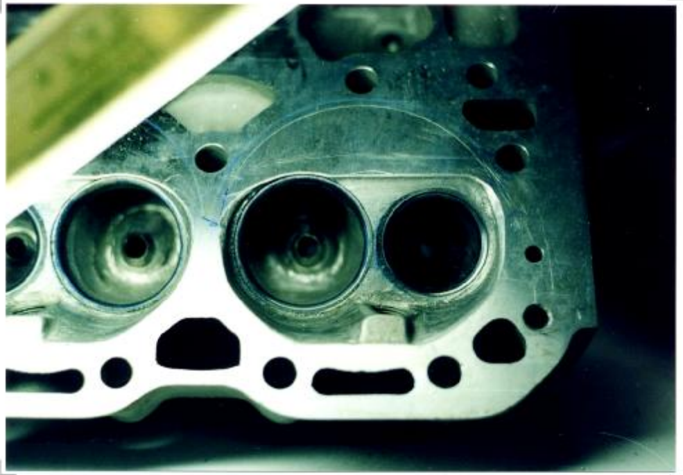
Bild 16: Der fertige Brennraum mit abgeschlossenen Ventilsitz-Fräsarbeiten, geglätteten Brennraumwänden und leichter Brennraumkantenwegnahme bis zur angezeichneten Zylinderwandung (siehe Pfeil), um die Strömung günstig zu beeinflussen.
