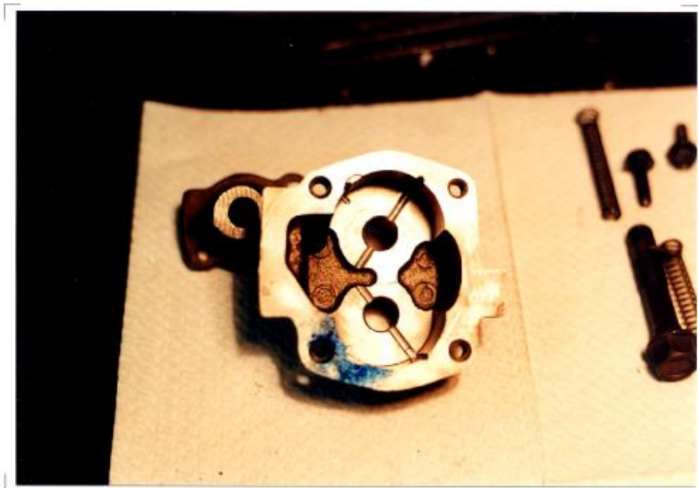
Bild 22: Druckausgleichsschlitze im Ölpumpengehäuse...
