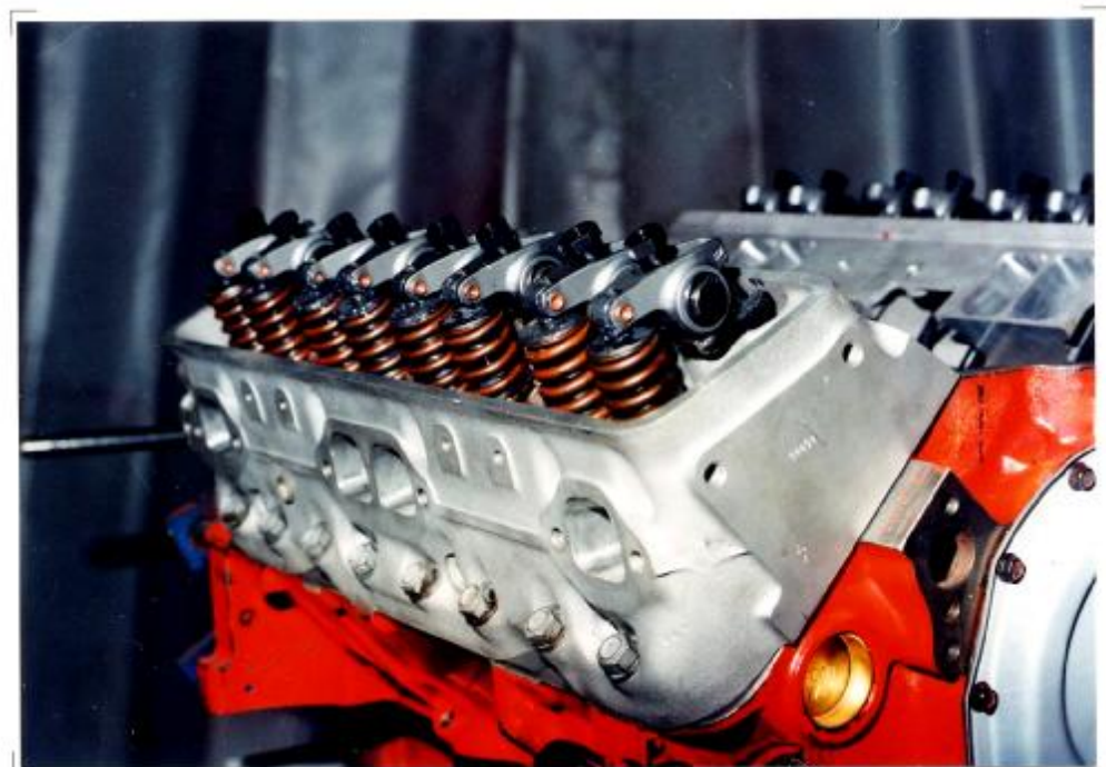
Bild 20: Fertig montierter Ventiltrieb.
