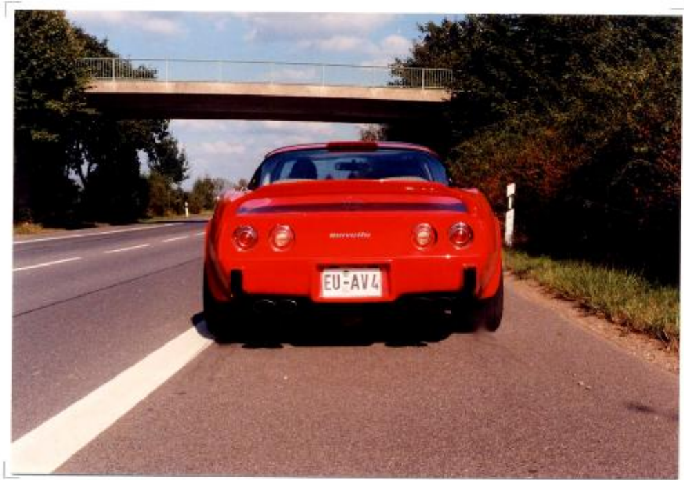
Bild 25: Corvette bei Beginn der Beschleunigung. Bei genauer Betrachtung sind die durchdrehenden Hinterräder erkennbar.
