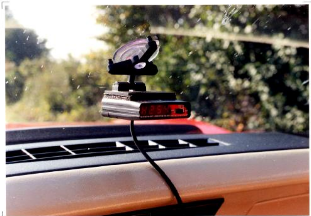
Bild 26: Meßgerät G-Tech/Pro mit angezeigter Radleistung des letzten Meßdurchganges.
