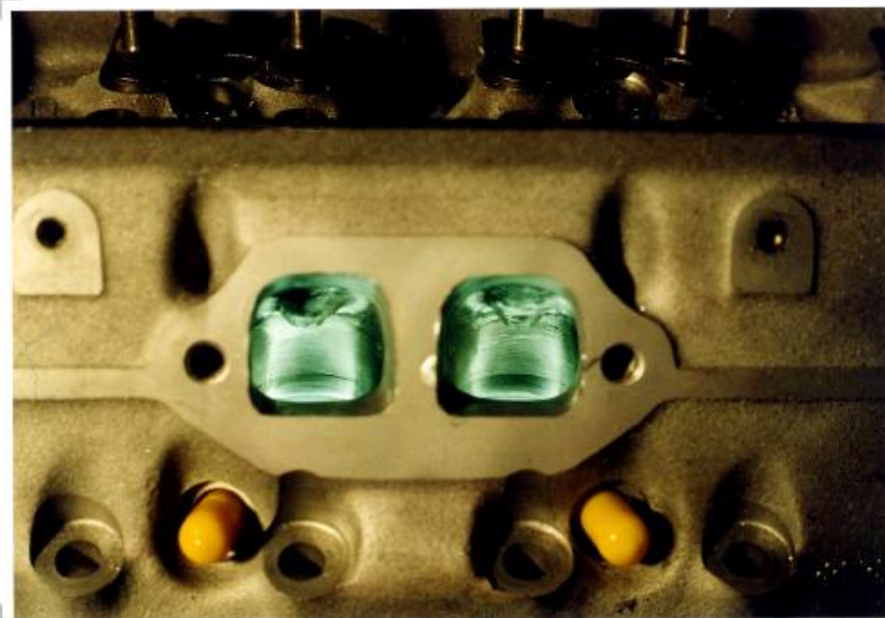
Bild 13: Nach der Fertigstellung! Erweiterter Kanal mit weggefrästen Ventilführungen und angeglichenen Ventilsitzringen. Die Unterkante des Kanals wurde nicht weggefräst und der Dichtung angepaßt, da diese Kante als Anti-Rückströmkante während der Ventilüberschneidung bei niedrigen Drehzahlen dient, und ein Rücksaugen der Abgase verhindern soll.
