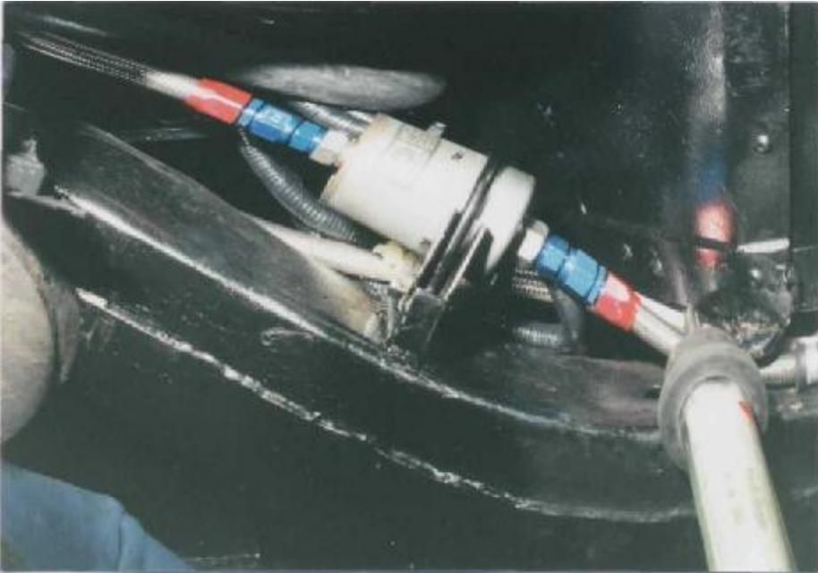
Bild 19: Montierter Hochdruckfilter
