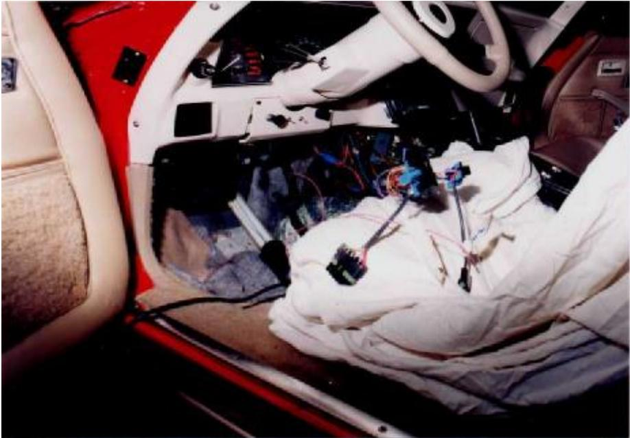
Bild 22: Kabelbaumaustritt im Fahrerfußraum
