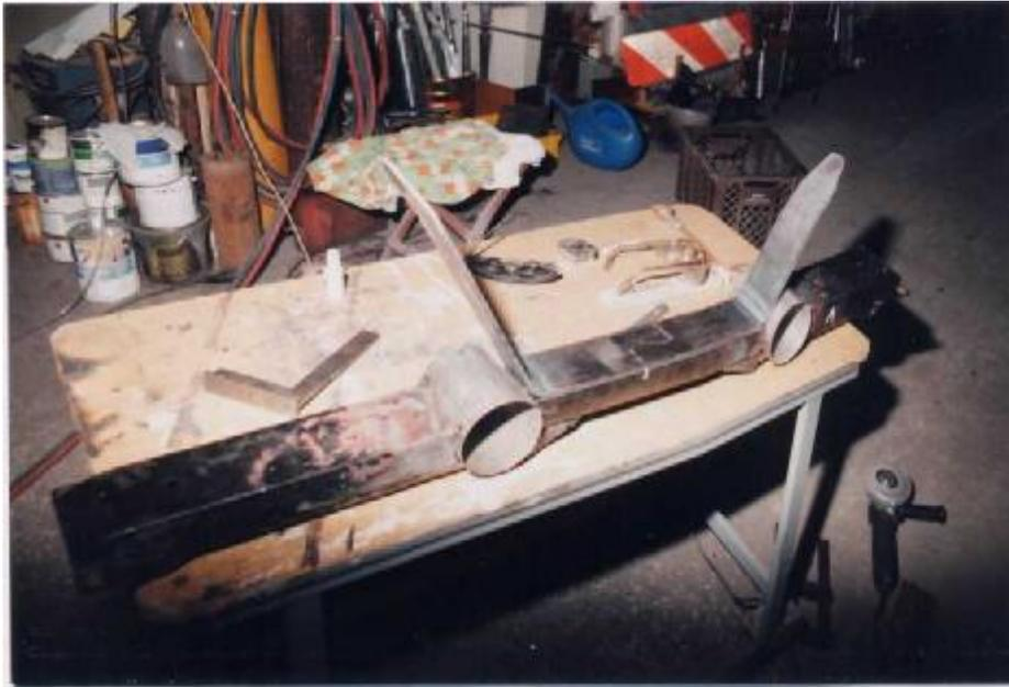
Bild 8: Traverse mit auf der Unterseite befindlichen Verstärkungslasche, die warm um die neuen Rohrdurchführungen herumgezogen wird.
