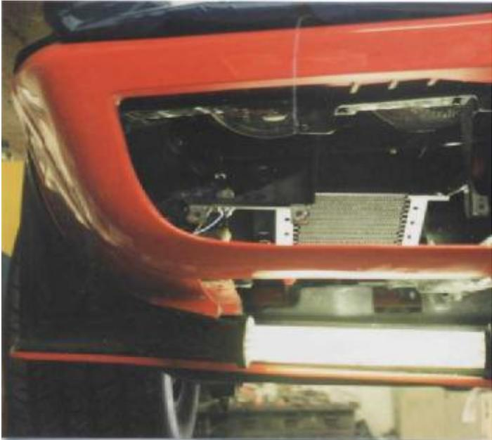
Bild 15: Getriebeölkühler
