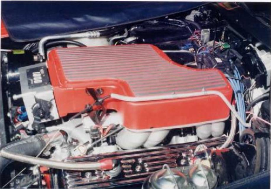
Bild 17: Fast komplett montierte Anlage. Schön zu sehen ist hier das seitlich am "Plenum " befestigte Gaszug-Führungsrohr.
