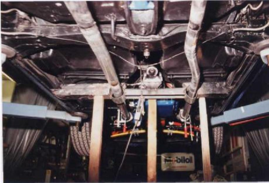
Bild 6: Anpassen der gesamten Traverse am Fahrzeug mit der Auspuffanlage (das Traversenmittelstück wird komplett neu erstellt).
