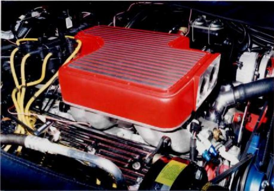
Bild 17: Montiertes "Plenum" des ACCEL SUPER RAM.
