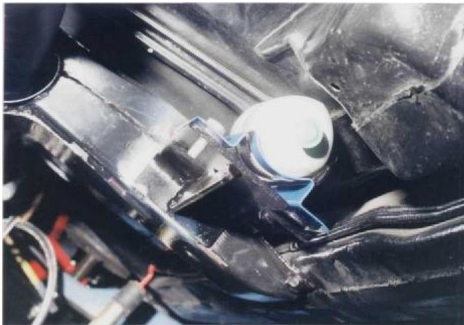
Bild 18: Montage der el. B.-Pumpe an Getr.-Traverse rechts auf eigens angefertigtem Halter.
