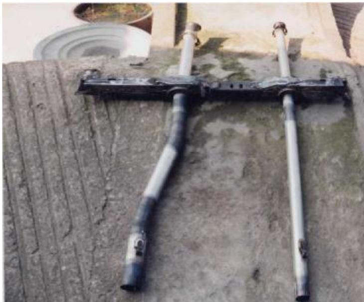
Bild 13: Traverse mit passender Auspuffanlage.
