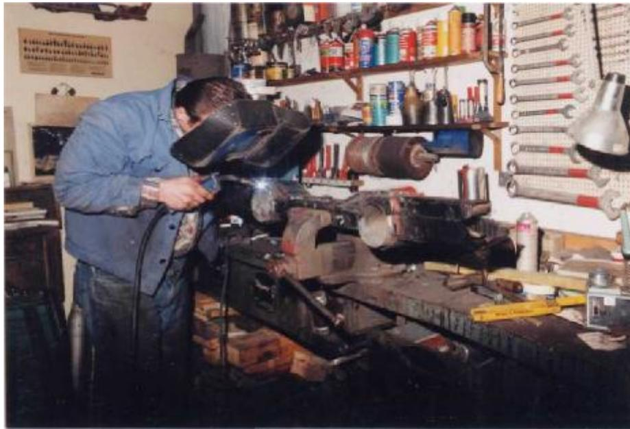
Bild 9: Nach dem Heften und einer immer wieder durchgeführten Anpassungskontrolle am Fahrzeug wird die Traverse komplett verschweißt.
