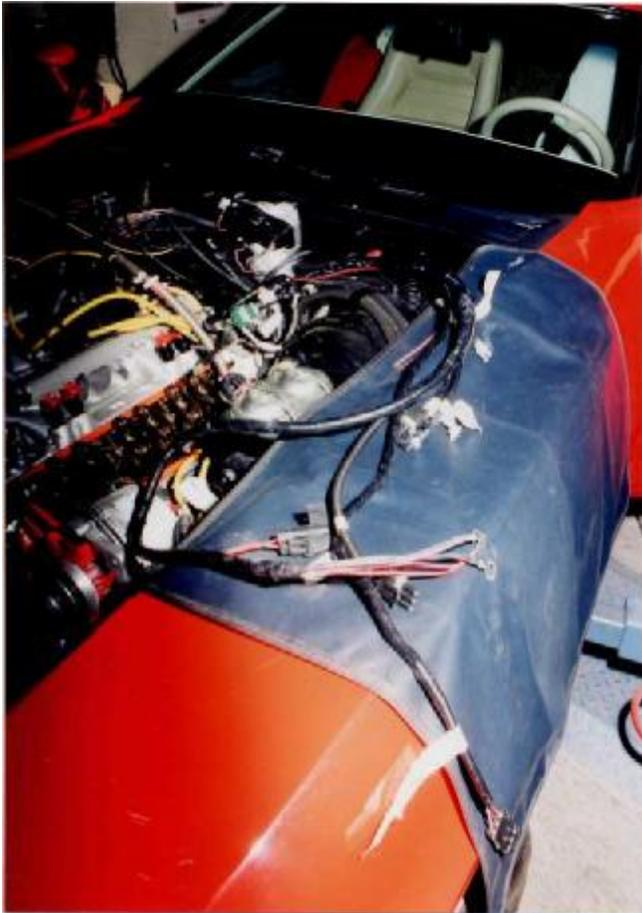
Bild 23: Kabelabgänge im Motorraum vor der Verlegung.
