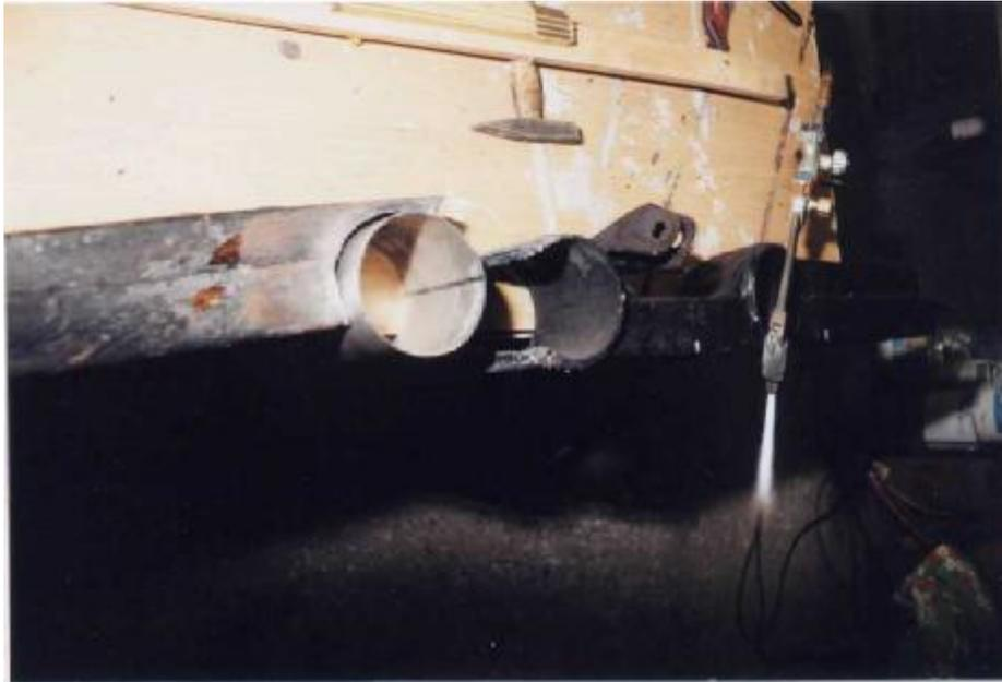
Bild 2: Durchbrennen der Traverse und Ausbrennen der in Bild 1 weiß markierten Aussparung mit eingesetzter neuer Rohrdurchführung (linke Fahrzeugseite).
