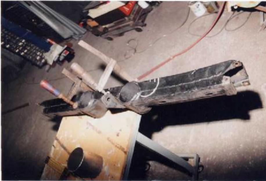
Bild 1: Originaltraverse mit weiß markierter neuen Auspuffrohr-Durchführung.
