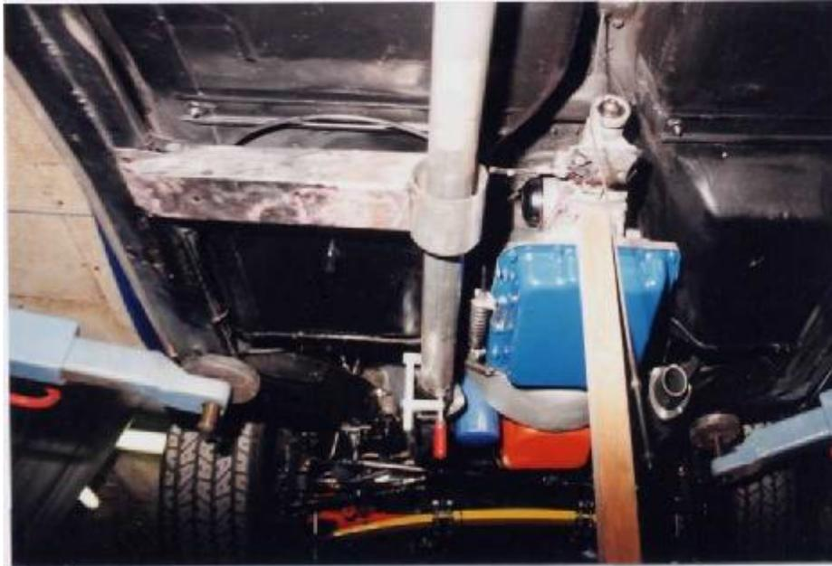
Bild 4: Anpassen der linken Traversenseite am Fahrzeug mit der Auspuffanlage links.
