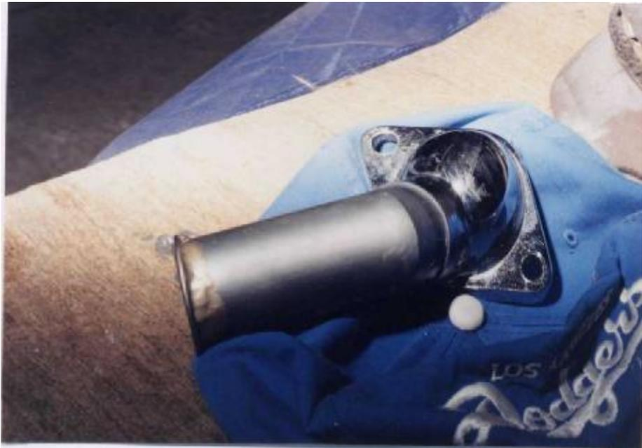
Bild 18: Verändertes Thermostatgehäuse (Waterneck) mit angelöteter Sicherheitswulst um ein Abrutschen des Kühlerschlauches zu verhindern.
