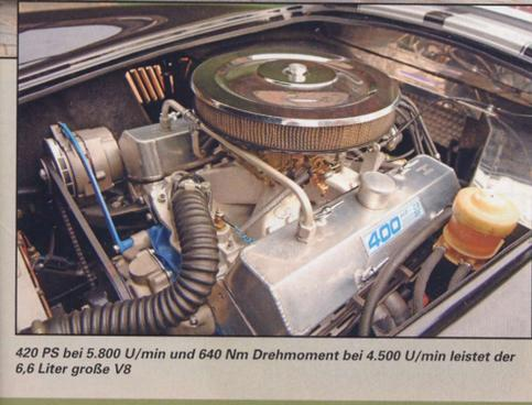
420 PS bei 5.800 U/min und 640 Nm Drehmoment bei 4.500 U/min leistet der 6,6 Liter große V8
