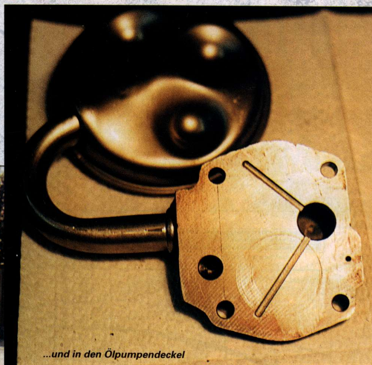
Axel fräst Druckausgleichsschlitze in das Ölpumpengehäuse ...
